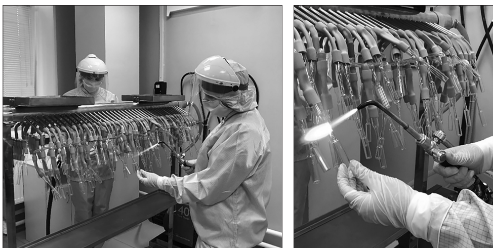
Рис. 1. Проведение технологического процесса запайки ампул под вакуумом
